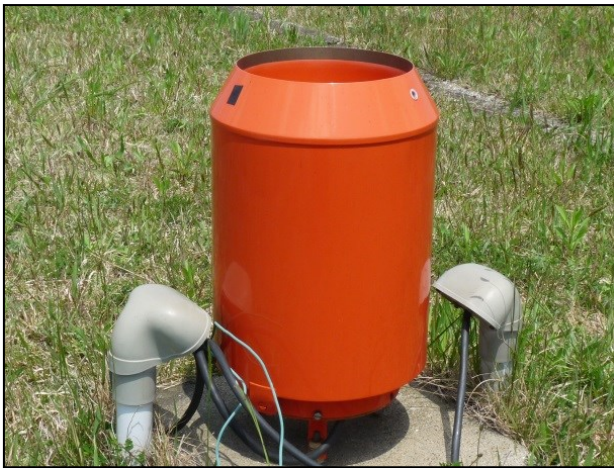
写真 1 転倒ます型雨量計の外観
